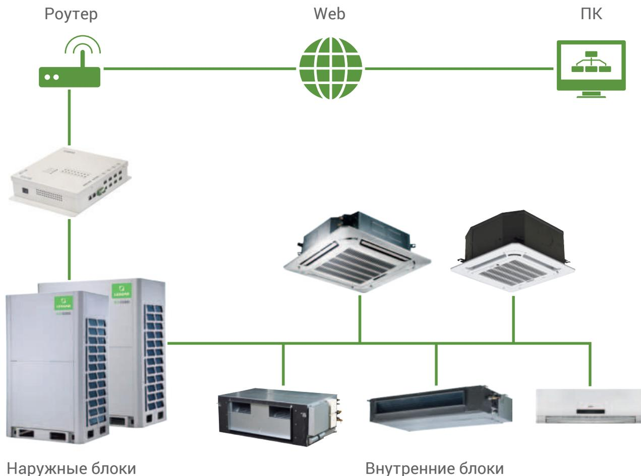
Система PRO IM разработана специально для централизованного управления системой LMV и позволяет осуществлять полный контроль и мониторинг всех функций системы.
