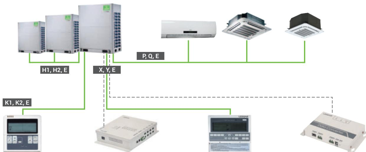
Пульт управления для наружных блоков (до 8 систем и до 32 наружных блоков)
